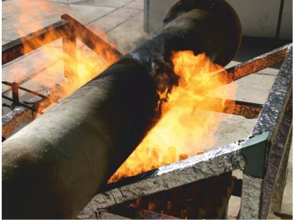
Petrokimya endüstrisi için CTP boru yanmazlık testi
