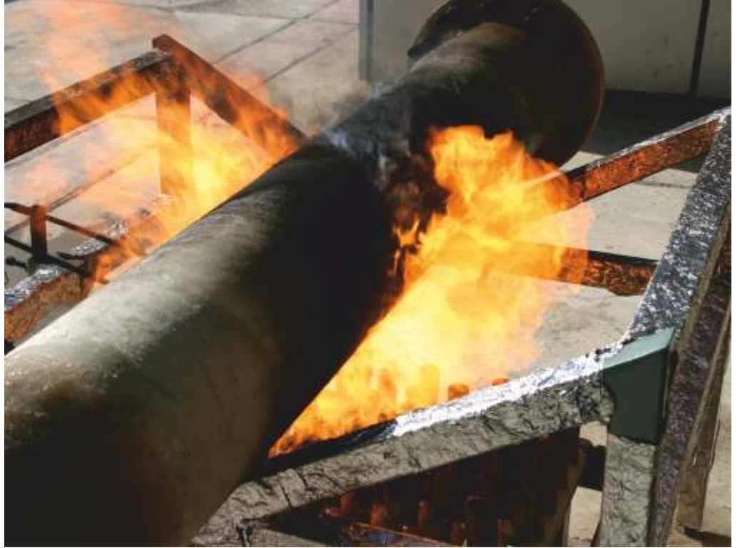
Petrokimya endüstrisi için CTP boru yanmazlık testi
